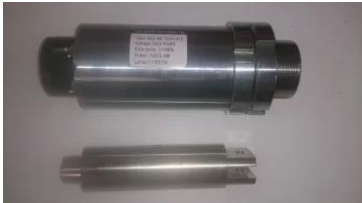
Cewka luzownika typ GCz-50 12/V1472
