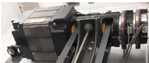
59601922 Wciągarka bezreduktorowa FMB130-LS-4B512 Schindler
