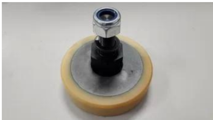
95664300-05 Rolka D.125/20X30MM; łożysko 6204-2RS plus śruba mimośrodowa ACLA THYSEN
