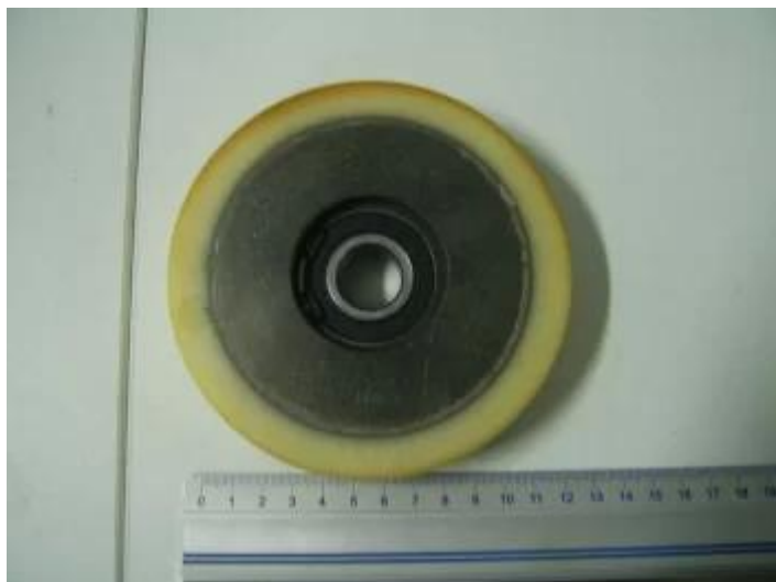
Rolka kabinowa D.125/20 X 30 MM; łożysko 6204-2RS
